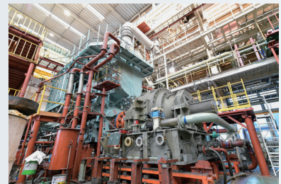
大型船舶用エンジン 型式:6UEC35LSE-Eco-B2
