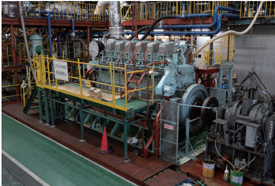
製造したエンジンのテストを行う 「運転機関台」
